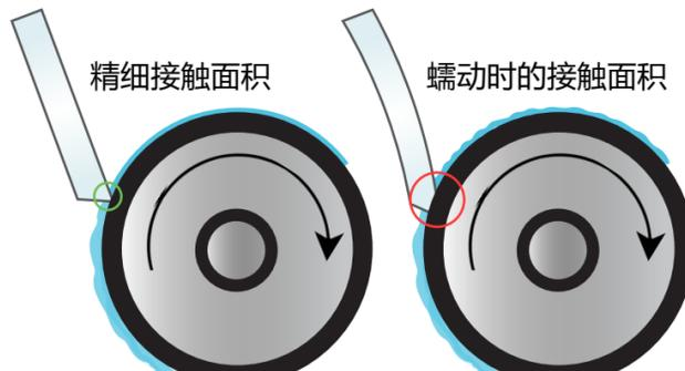
产生蠕变时，刮刀与网纹辊的刮刀角度会减小、接触面积会增加，导致刮刀无法高效率执行刮墨，此时更多的油墨传递到网纹辊上。
